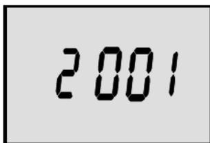
**注：**如在发动机自检过程中显示“2001”，表示您的发动机是型号年度 2002 以前的产品。用
