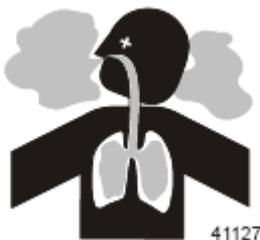
发动机排放的尾气中包含对人体有害的一氧化碳。远离发动机尾气排放集中的区域。在发动机运行时，应让游泳者远离船艇，不要坐、躺、站在游泳平台和登船梯上。航行时，勿让乘员立即到船艇后端（牵引平台，冲浪木板），这个危险的举动不仅使人处于尾气排放集中的区域，还有可能被螺旋桨误伤。
