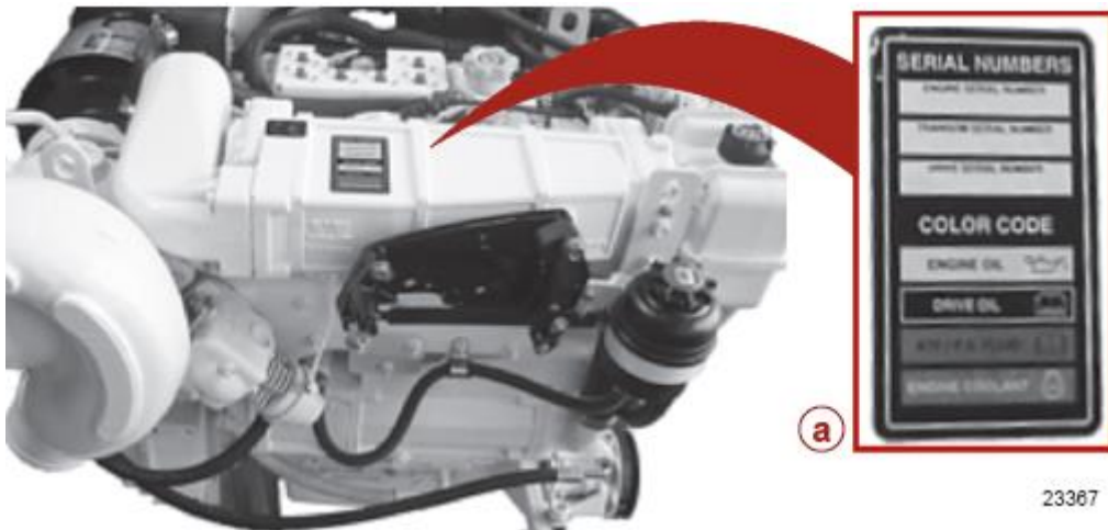
图示为 2.8 型, 4.2 型与之类似 a - 序列号和维护保养色码标签
