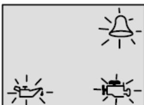
显示警“钟”、“发动机”和“润滑油壶”图形符号，报警蜂鸣器开始连续鸣响，提示驾驶员滑油泵由于电气原因停止工作，没有润滑油供给发动机。应尽快将发动机停机。发动机 Guardian 系统将开始减少发动机的输出功率。请与向您出售产品的代理商联系，以得到帮助。
