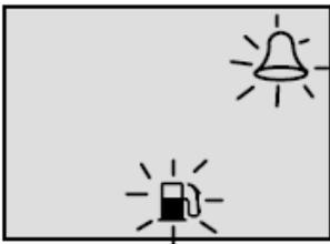
当燃油分水过滤器中积水达指定高度时，将显示“警钟”和“燃油杯”图形符号，报警蜂鸣器将开始每隔 2 分钟连续鸣响 4 次。某些发动机配用的燃油分水过滤器中的积水，可以放掉。
