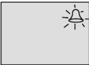
显示“警钟”符号，报警蜂鸣器连续鸣响，提示驾驶员发动机转速已超过最高允许转速。系统将自动把发动机转速降至允许范围之内。
