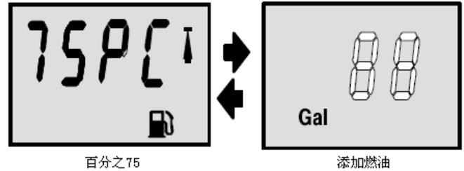
标定“FULL”—所显示的“FULL%”，在油箱容积的百分比和以进入 Cal 2 的总容量为基数的燃油添加量之间交替变化显示。向油箱注满燃油，然后按下键
