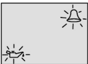
显示警“钟”和“润滑油壶”图形符号，报警蜂鸣器每隔 2 分钟鸣响 4 次，提醒驾驶员装在发动机上的滑油箱（机附滑油箱）中，油位已降低到临界高度。当润滑油接近用光时，蜂鸣器开始连续鸣响，发动机 Guardian 系统开始减少发动机的输出功率。
