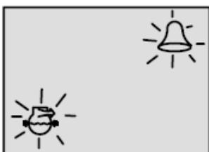
显示警“钟”和“水压表”图形符号，报警蜂鸣器连续鸣响，提醒驾驶员冷却系统中水压不足。发动机 Guardian 系统将开始减少发动机的输出功率。
