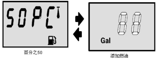
标定 75%—所显示的“75%”，在油箱容积的百分比与以进入 Cal 2 的总容量为基数的燃油添加量之间交替变换显示。按所显示的具体量添加燃油，然后按下
