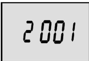
**注：**如在发动机自检过程中显示“2001”，表示您的发动机是型号年度 2002 以前的产品。用
