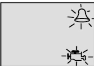
将显示“警钟”和“发动机”图形符号，提示驾驶员发动机有问题。如报警系统检测到这种问题会造成发动机产生永久性的损坏，发动机 Guardian 系统将开始减少发动机的输出功率。
