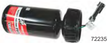
已安装 WIF 传感器，橡胶套翻转
